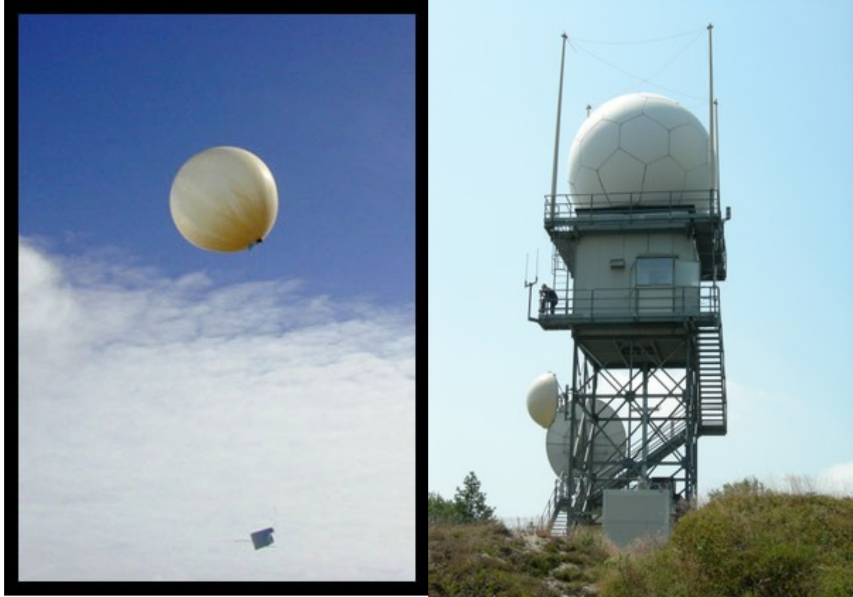
Un pallone sonda, utilizzato per effettuare i RadioSondaggi, e la strumentazione del Radar Doppler del Monte Settepani ( Radar Arpa Piemonte ) a destra. Sia i radiosondaggi sia i radar meteorologici sono fondamentali per prevedere i temporali. Foto a cura di www.arpa.piemonte.it e www.meteovalmorea.it
